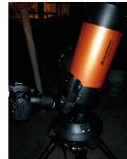
Figura 1. Telescopio de la institución, un Celestron de 4" de amplitud y distancia focal de 1030mm.
